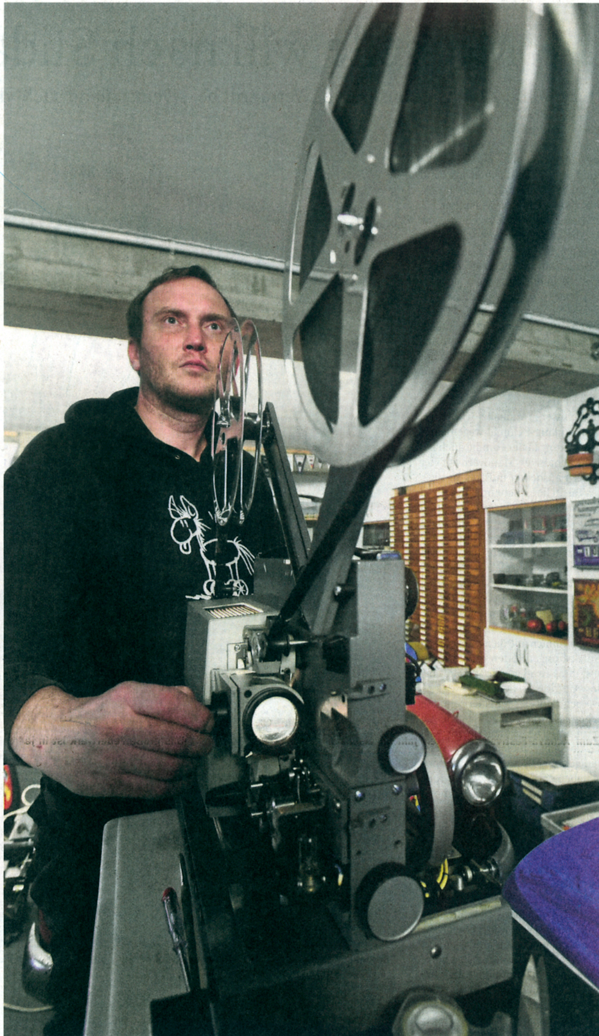
Digitalisierung von alten 16-Millimeter-Filmen vom AWE-Schmalfilmstudio aus dem Archiv der Stiftung "Automobile Welt Eisenach". Enrico Martin an einem 16-Millimeter-Filmprojektor. Damit digitalisiert er das alte Filmmaterial.
